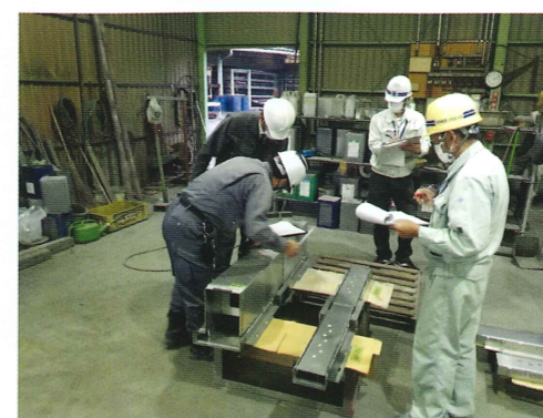
製作工場での製品検査（お客様立会い検査）
